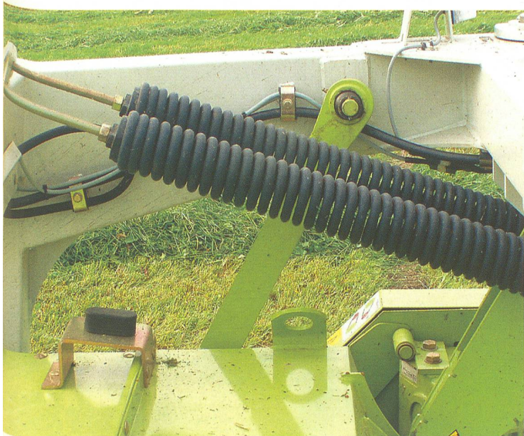
Zwei Spiralfedern dienen der Mäherwerkentlastung. Mittels Schraubenschlüssel ist die Entlastung einstellbar. (Foto: R. Hunger)
