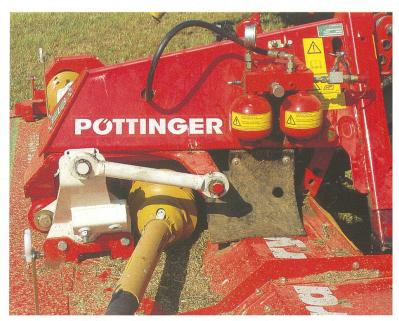
Aufwändige Konstruktion, damit das Frontmähwerk bodenschonend und anpassungsfähig über den Boden gleitet. (Foto: R. Hunger)
