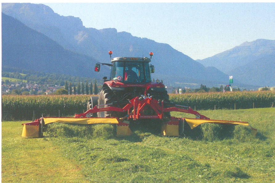
In der Mitte angelenkte Heckmähwerke benötigen eine aufwändige Konstruktion, damit genügend Pendelweg erhalten bleibt. (Foto: P. Wolf)
