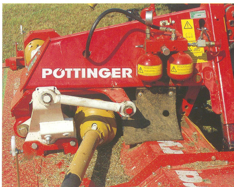
Aufwändige Konstruktion, damit das Frontmäherwerk bodenschonend und anpassungsfähig über den Boden gleitet. (Foto: R. Hunger)
