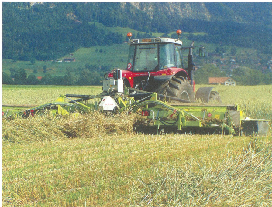
Das Mähgut der beiden Heckmähwerke wird auf die Schwad des Frontmähwerks zusammengeführt. (Foto R. Hunger)
