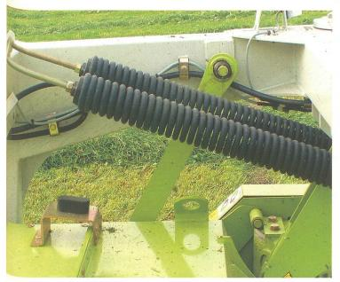
Zwei Spiralfedern dienen der Mähwerkentlastung. Mittels Schraubenschlüssel ist die Entlastung einstellbar. (Foto: R. Hunger)
