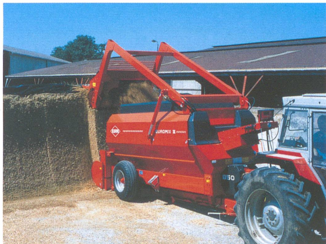
Kuhn EuroMix II, gezogener Futtermischwagen als Selbstbefüller. Horizontalmischer weisen eine niedrige Konstruktion auf und sind eher schmal gebaut.
