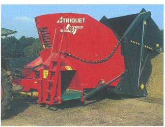
Trioliet, gezogener Vertikalmischer als Selbstbefüller.
