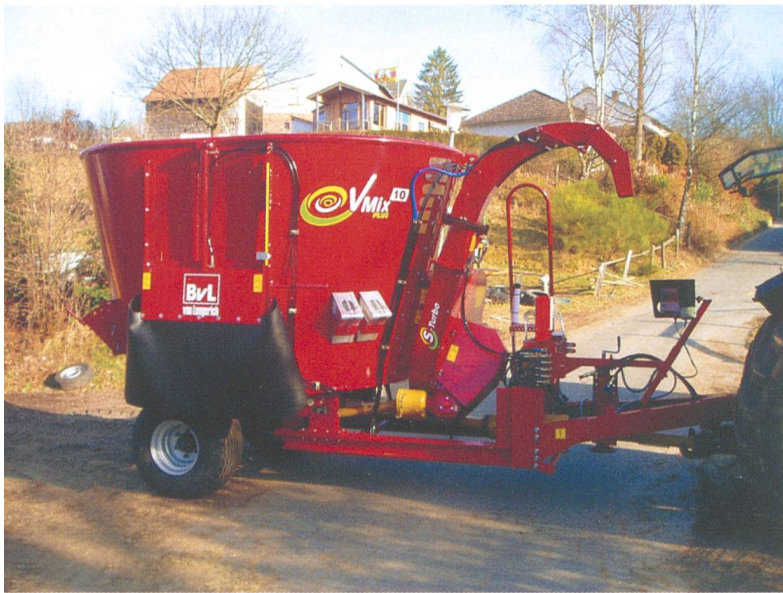
BVL Vertikalmischer mit patentiertem Strohgebläse
