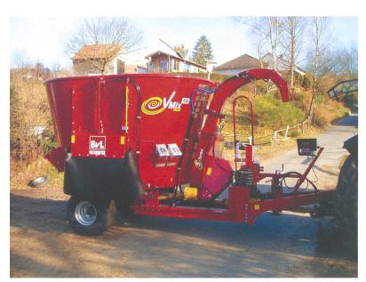
BVL Vertikalmischer mit patentiertem Strohgebläse
