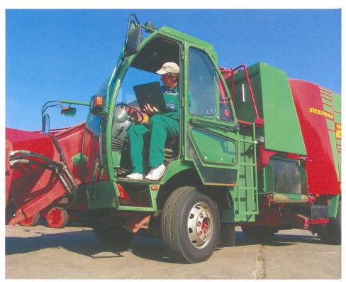
Strautmann legt besonderen Wert auf intensive Produktbetreuung. Hier der wendige VertiMix-Vertikalmischer als Selbstfahrer bei einer elektronischen Funktionsüberprüfung.
