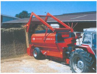
Kuhn EuroMix II, gezogener Futtermischwagen als Selbstbefüller. Horizontalmischer weisen eine niedrige Konstruktion auf und sind eher schmal gebaut.
