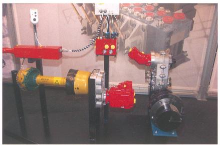
Treibachsanhänger: Hydrostatischer Radnabenmotor für den Fahrantrieb auf grossen Anhängern zur Unterstützung des Traktionsvermögens des ganzen Anhängerzugs.
