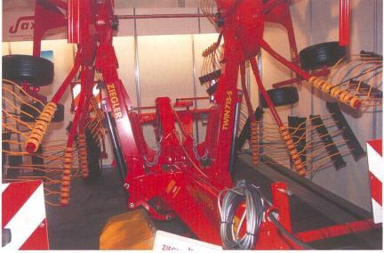
Vergleichsweise einfache Technik bei Ziegler: Das Gerät ist so klappbar, dass die Doppelzinkenrechen für die Strassenfahrt nicht demontiert werden müssen.
