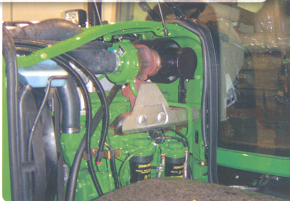
Kooperation zwischen Matra und Airmeex-Partikelfilterhersteller: Kompakter Einbau eines Partikelfilters an John-Deere-Traktor. Der Partikelfilter wird an Stelle des Schalldämpfers nahe beim Motor eingebaut. Er ist so dimensioniert, dass er ohne Veränderungen am Traktor an den Auspuffstrang angeflanscht werden kann. (Beispiel: John Deere 6-Zylinder-Motor, Bild Matra)
