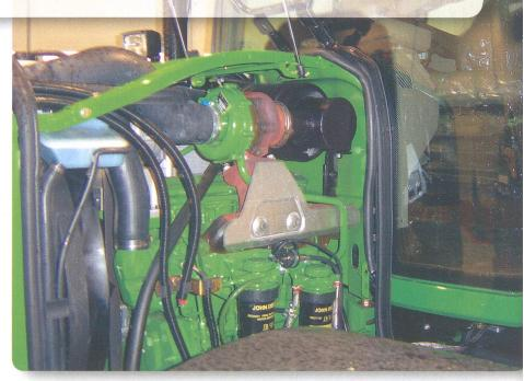
Kooperation zwischen Matra und Airmeex-Partikelfilterhersteller: Kompakter Einbau eines Partikelfilters an John-Deere-Traktor. Der Partikelfilter wird an Stelle des Schalldämpfers nahe beim Motor eingebaut. Er ist so dimensioniert, dass er ohne Veränderungen am Traktor an den Auspuffstrang angeflanscht werden kann.
