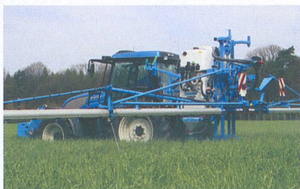
Anbau-Feldspritze EuroLux 1200 TL mit 21-m-Gestänge
