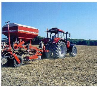
Obschon sich der neue Reifen durch gutes Fahrverhalten und Laufleistung auszeichnet, schont er den Boden dank seiner grösseren Reifenlauffläche.
