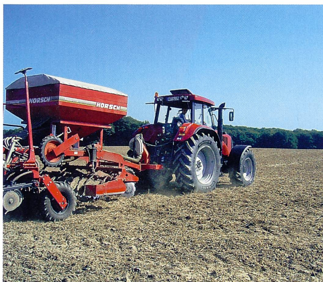
Obschon sich der neue Reifen durch gutes Fahrverhalten und Laufleistung auszeichnet, schont er den Boden dank seiner grösseren Reifenlauffläche.
