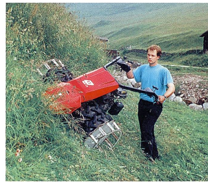
M3-D-Profi-Bergmäher von Reform. Er verfügt über patentierte Lager- und Zwischenantriebszapfen und Zahnkurbelbetrieb. Dieser «Rotations-Mähetrieb» verursacht keine Dreh- und Gleitbewegung im Messerkopf (Bild Reform).
