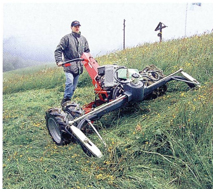
Der Hangmäher Rapid Tecno mit Motor-Neigungsverstellung (Bild: Gallus Steiner).
