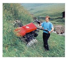
M3-D-Profi-Bergmäher von Reform. Er verfügt über patentierte Lager- und Zwischenantriebszapfen und Zahnkurbelbetrieb. Dieser «Rotations-Mähantrieb» verursacht keine Dreh- und Gleitbewegung im Messerkopf (Bild Reform).
