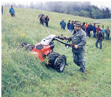
Hangmäher Aebi CC66 mit «Servolenkung» über bewegliche Holme (Bild: Gallus Steiner).
