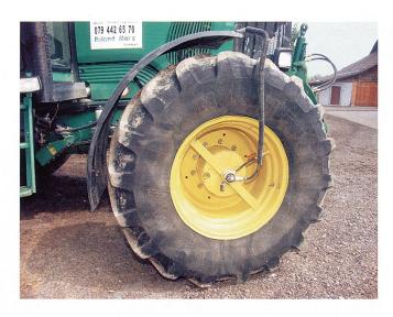
Die automatische Reifendruckregelung optimiert die Ackerund Strassenfahrt.
