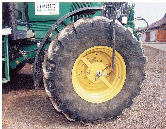
Die automatische Reifendruckregelung optimiert die Acker- und Strassenfahrt.
