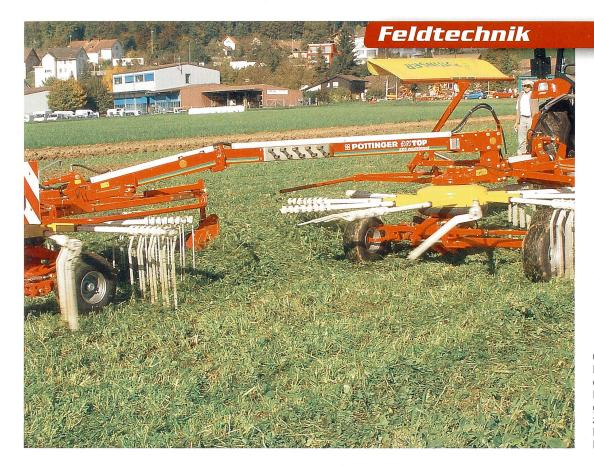
Queranpassung des hinteren Kreisels durch ein Drehlager im Rahmen und durch gelenkige Verbindung zwischen Rahmen und Kreiseleinheit beim Pöttinger Eurotop 601.
