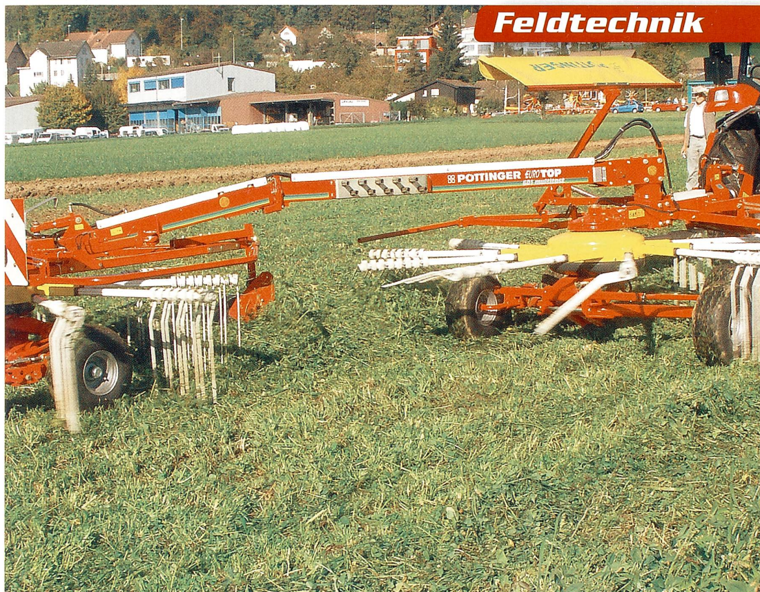
Queranpassung des hinteren Kreisels durch ein Drehlager im Rahmen und durch gelenkige Verbindung zwischen Rahmen und Kreiseinheit beim Pöttinger Eurotop 601.
