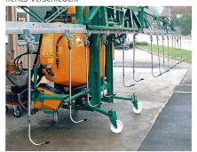
Das Spray-Rohr kann durch Schnellverschlüsse rasch am Feldbalken montiert und demontiert werden.
