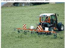
Der neue Turboheuer wurde speziell für den Einsatz im Berggebiet konzipiert.
