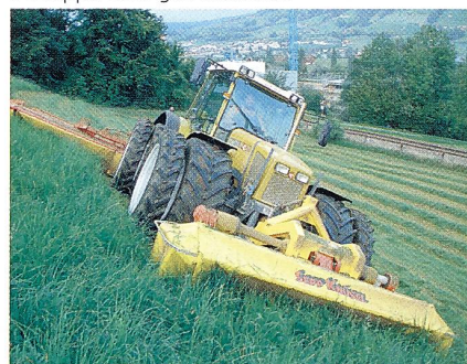
Das Blitz-Frontscheibenmäherwerk mit Aufbereiter ist mit 3 m Schnittbreite und einem Gewicht von nur 670 kg das leichteste auf dem Markt.
