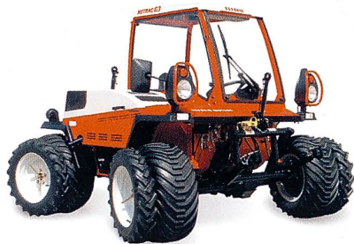
REFORM Metrac G3: durchzugskräftiger, sparsamer 40-PS-Saugdiesel erfüllt Stufe 3a
