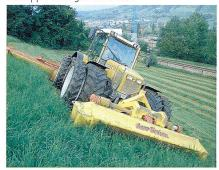
Das Blitz-Frontscheibenmähwerk mit Aufbereiter ist mit 3 m Schnittbreite und einem Gewicht von nur 670 kg das leichteste auf dem Markt.
