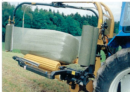
Die bewährte RDS-Computersteuerung kontrolliert den gesamten Wickelvorgang.
