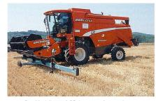
Das Modell 255 LCS des neuen Integrale von Laverda fügt sich nahtlos in die bisherige Serie der Integralmaschinen ein. Mit 20% Seiten- und 8% Längsausgleich wird der Mähdrescher die meisten Ansprüche erfüllen.
