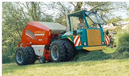
Die SF 132 ist ein Alleskönner, der auf Wunsch auch mit einem Wickler ergänzt werden kann.
