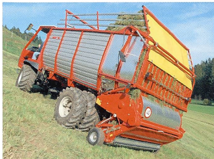
Ladegerät Aebi LD49: Das Pendel-Pick-up wird gestossen und passt sich jeder Unebenheit exakt an.
