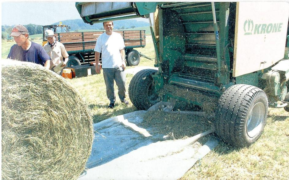
Die Rollenpresse als Konstantkammerpresse weist einen ansteigenden Leistungsbedarf auf, bis gegen 66 kW beim Abbinden. Bänderpressen benötigen von Pressbeginn bis zum Abbinden eine annähernd konstante Leistung im Bereich von 30 kW.
