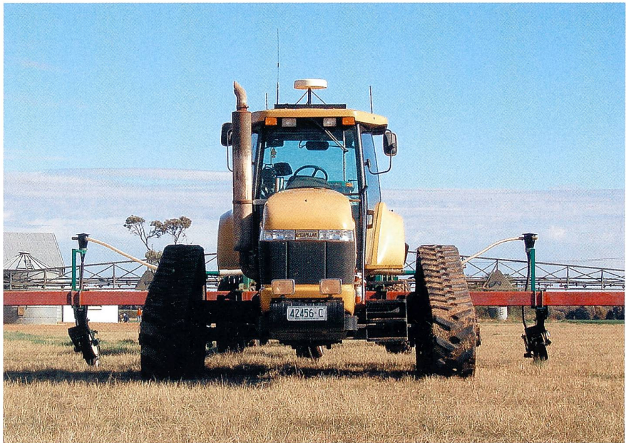
Abb. 3. Beim Controlled traffic farming fahren sämtliche Fahrzeuge zentimetergenau mittels GPS über die Jahre hinweg auf denselben Fahrspuren. In Australien erlebt dieses Verfahren einen grossen Aufschwung. Ein viel versprechender Ansatz zur Minderung der Bodenverdichtung auch für die Schweiz?
