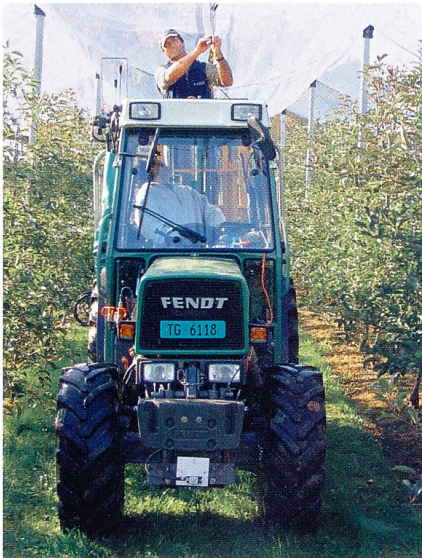
Abb. 1. Prototyp eines automatischen Lenksystems für den Obstbau von Agroscope Reckenholz-Tänikon ART. Links Testfahrt in Apfelanlage, rechts: Lenkeingriff am Lenkrad.
