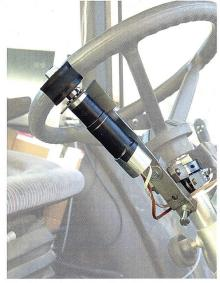
Abb. 1. Prototyp eines automatischen Lenksystems für den Obstbau von Agroscope Reckenholz-Tänikon ART. Links Testfahrt in Apfelanlage, rechts: Lenkeingriff am Lenkrad.
