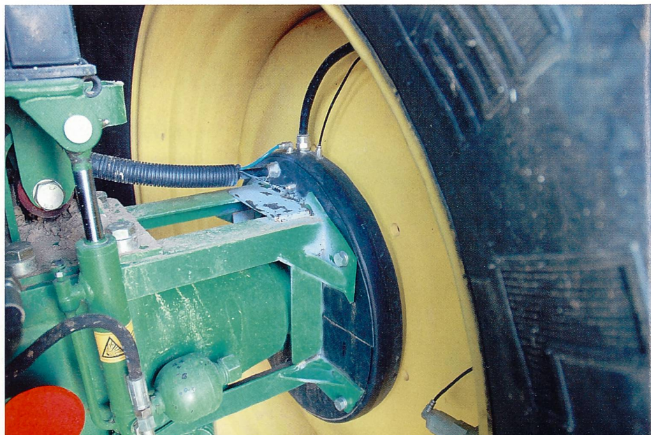
Abb. 2. Die innenliegende Luftübertragung ermöglicht die Reifendruckregelung während der Fahrt. Exponierte und ausserhalb der Kotflügel liegende Luftschläuche gehören der Vergangenheit an.
