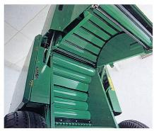
Blick in die neue Festkammerpresse 568 MultiCrop mit Presswalzen vorn und Stabkette hinten.
