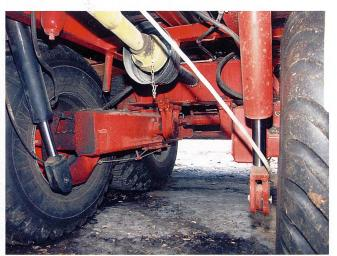
Mit der Lift-Achse können die vorderen Räder nach Bedarf entlastet werden. Somit kommt mehr Druck auf die Traktorhinterachse.
