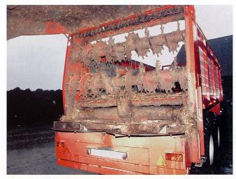
Zwei horizontale Fräswalzen sorgen für eine gleichmässige Dosierung des Streugutes auf die grossen Streuteller.
