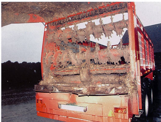
Zwei horizontale Fräswalzen sorgen für eine gleichmässige Dosierung des Streugutes auf die grossen Streuteller.
