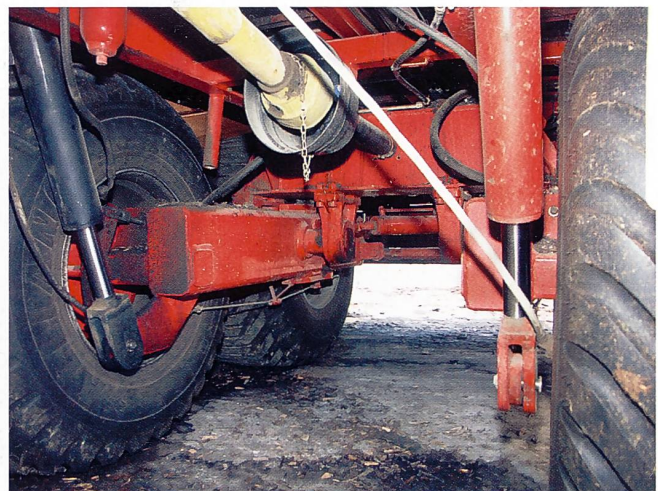
Mit der Lift-Achse können die vorderen Räder nach Bedarf entlastet werden. Somit kommt mehr Druck auf die Traktorhinterachse.
