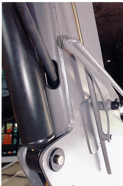
Besonderheit der neuen Serie: Alle Schlauchleitungen verlaufen in den Schwingen.
