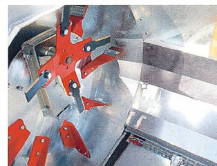
Die neue Bauform verhindert das Aufstossen des Mistes.
