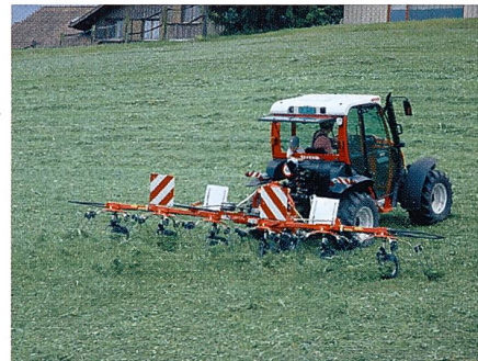
Fella-Turboheuer TH 601 D-Hydro, mit 5,7 m Arbeitsbreite
