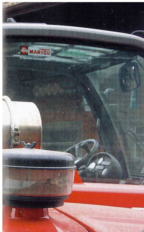
Im Einsatz im Kompostierwerk Haab-Bossert GmbH in Wädenswil ZH: Manitou für CHF 17000 mit einem Partikelfilter für Kommunalarbeiten nachgerüstet. Noch fehlen die Erfahrungen zur Funktionsfähigkeit im Langzeiteinsatz.
