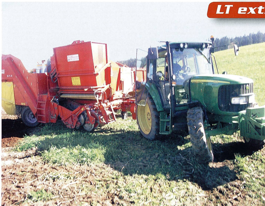
Zeitsparendes Wendemanöver mit Unterstützung der gelenkten Achse des Kartoffelvollernters.
