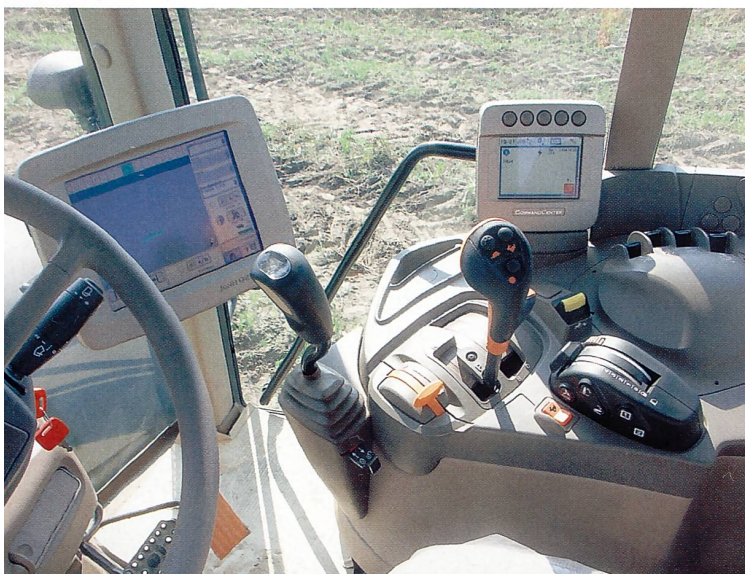
Neue Premium-Kabineausstattung mit CommandCenter rechts und ISOBUS-Terminal links.
