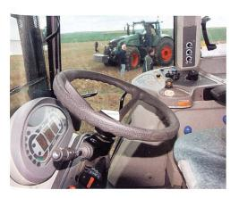
Übersichtliche Bedienelemente in der neuen 300er-Vario-Serie mit der «Multifunkionskugel» auf der rechten Konsole zur Steuerung des Vario-Getriebes. Im Hintergrund zieht die 900er-Vario-Serie die Aufmerksamkeit auf sich.
