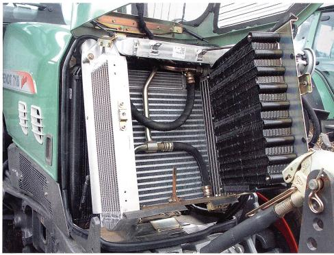
Kühlsysteme von der 400er- bis zur 900er-Serie klappbar und wartungsfreundlich unter der Motorhaube angeordnet.
