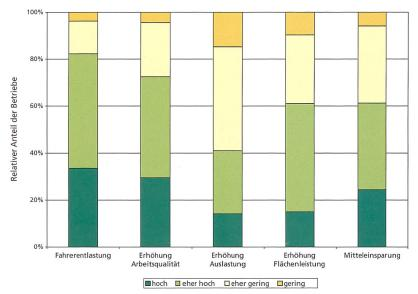
Abb. 3: Einfluss von zusätzlichen elektronischen Komponenten im Traktor auf Fahrerentlastung, Erhöhung von Arbeitsqualität, Auslastung und Flächenleistung sowie Mitteleinsparung.
