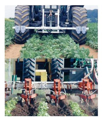
Abb. 4: Parallelfahrsysteme ohne GPS: links Ultraschalltaster von Reichhardt-Steuerungstechnik zur Erkennung von Fahrgassen, rechts Eco-Dan-Kamera zur Lenkung des Hackgeräts zwischen den Reihen.
