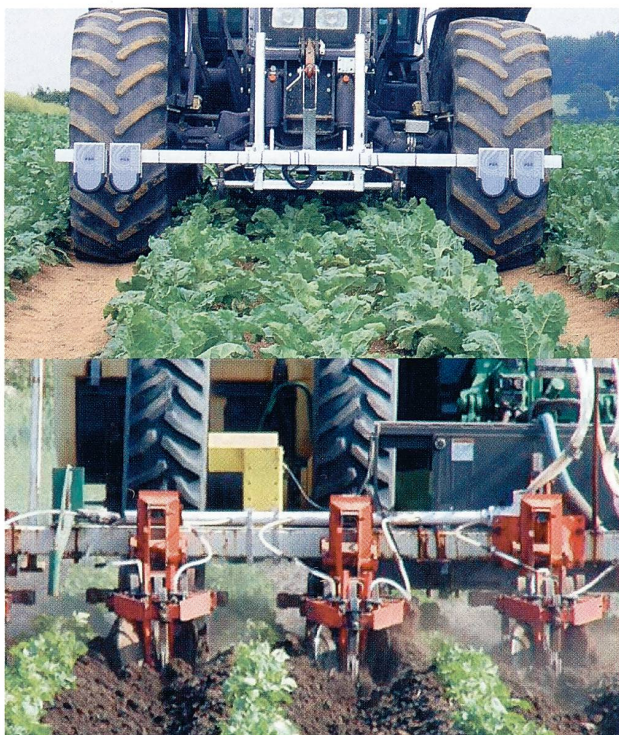
Abb. 4: Parallelfahrssysteme ohne GPS: links Ultraschalltaster von Reichardt-Steuerungstechnik zur Erkennung von Fahrgassen, rechts Eco-Dan-Kamera zur Lenkung des Hackgeräts zwischen den Reihen.
