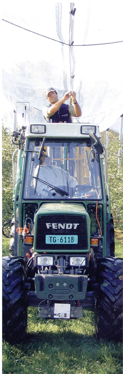
Abb. 1: Prototyp eines automatischen Lenksystems für den Obstbau von Agroscope Reckenholz-Tänikon ART: Traktor in Apfelanlage.
