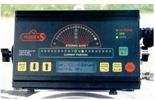
Abb. 6: Manuelle Parallelführungsysteme mit Lichtbalken: rechts Centerline 220 von LH Agro, oben Outback S von Agrocom.
