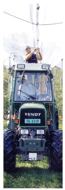
Abb. 1: Prototyp eines automatischen Lenksystems für den Obstbau von Agroscope Reckenholz-Tänikon ART: Traktor in Apfelanlage.
