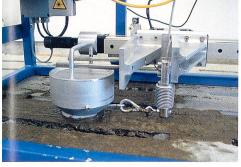
Mit einem für Stallböden entwickelten Messgerät kann die Rutschfestigkeit von Laufflächen auch unter Praxisbedingungen beurteilt werden.
