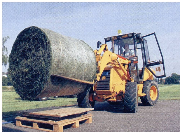
Abb. 8: Zur Bestimmung des Ballengewichts wird der fertige Rundballen auf eine Plattformwaage gelegt.
