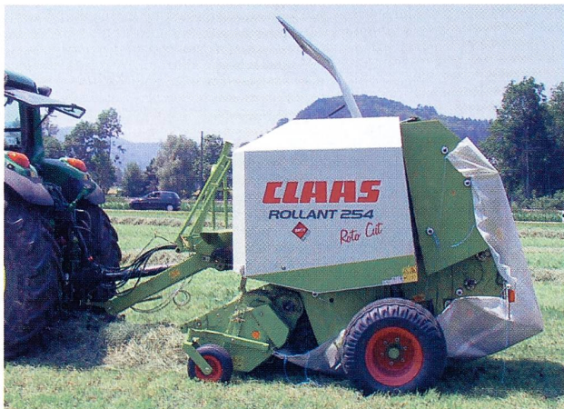
Abb. 5: Eine Folie fängt die Bröckelverluste während des Pressens auf.
