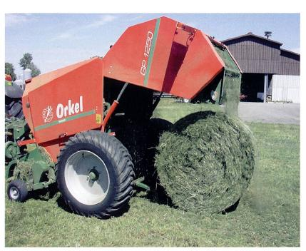
Abb. 1: Beim Pressen von Heu können je nach Presssystem 0,5 bis 2,6% des Futters verloren gehen.
