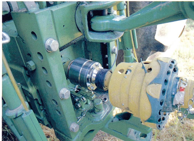
Abb. 7: Eine Drehmomentmessnabe misst den Leistungsbedarf während des Pressens.
