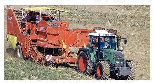
ckelt und deckt die Geschwindigkeitsbreite von 30 Metern zu 40 Kilometer pro Stunde ab. Das niedrige Gewicht pro PS wirke sich besonders beim Einsatz als hochbereifter Pflegetraktor und bei Grünlandarbeiten mit bodenschonender Breitbereifung positiv aus.
