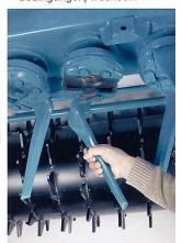
Unter dem Zinkenrotor: die Halbschale speziell geformt um den Zinken sicher zu halten und das zentrale Verschluss-System (SULKY)
