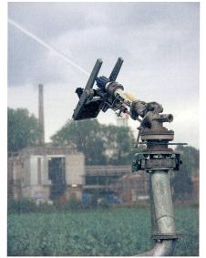
Wasserwerfer: Aufgebaut auf einer Haspel-Beregnungsmaschine, hat man die einfachste Technik, um grosse Flächen zu bewässern. Der Windeinfluss ist allerdings nicht unerheblich. Druck und Wasserdurchflussmenge müssen für das richtige Funktionieren zudem recht gross sein. Je nachdem kann man eine Wassermenge von bis zu 20 mm pro Stunde erwarten (Bild: Ueli Zweifel).
