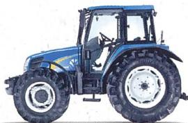
Modern, dynamisch, einfach zu bedienen! **NEW HOLLAND Universaltraktoren der Serie TLA** sind in der Mittelklasse kaum zu schlagen: Neu entwickelte New-Engine-Family-Motoren von 72 bis 100 PS mit einem Hubraum von 4,5 Litern und einem Drehmomentanstieg von bis zu 57% sorgen für hervorragende Zugkraft. Niedrig
