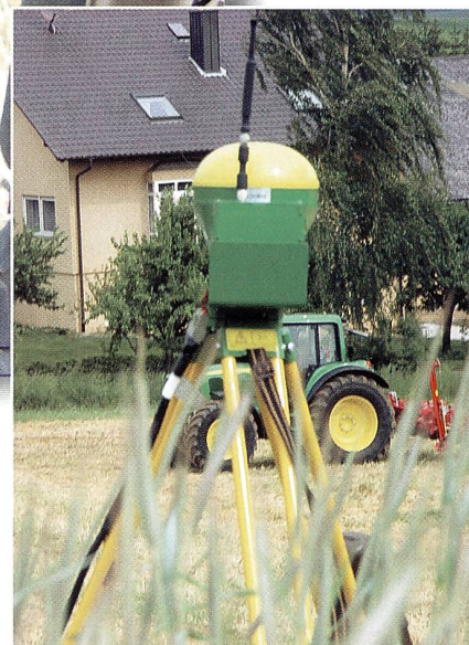
Der Empfänger am Feldrand (bis zu einer Entfernung von ca. 8 km) übermittelt. Das RTK-Korrektursignal für absolute Spurtreue.
