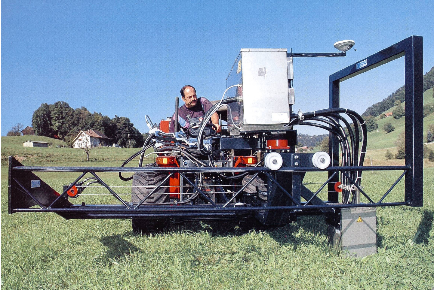
Prototyp zur Ampferbekämpfung mit Mikrowellen, aufgebaut auf einem Kleintraktor. Die GPS-Antenne dient der zentimetergenauen Bestimmung des Standorts der behandelten Pflanze für eine zeitversetzte Erfolgskontrolle.
