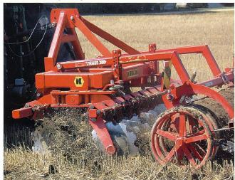
Abb. 4: Traditionelle Doppelherzschargrubber eignen sich hervorragend zum Einmischen von Stroh bei Arbeitstiefen von zirka 15 cm. Für flaches Arbeiten ist eine Umrüstung auf Gänsefussschare notwendig.
