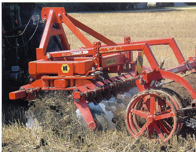
Abb. 3: Kurzscheibeneggen schälen ganzflächig, erlauben flaches Arbeiten (5 cm), verstopfen nicht und sind sehr schlagkräftig. Deren Anschaffung ist allerdings nicht ganz billig, was eine genügende Auslastung bedingt.
