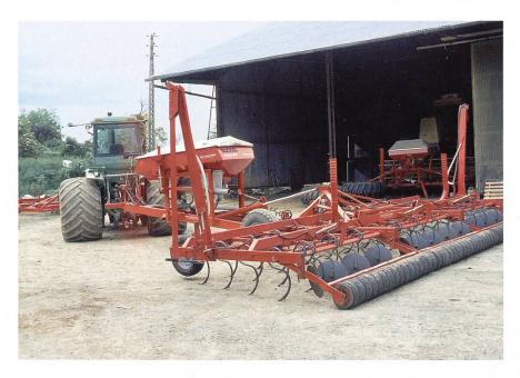
Abb. 2: Ist das Stroh sauber geräumt, eignet sich auch die alte Federzinkenegge für die Stoppelbearbeitung. Eine Weiterentwicklung der französischen Firma Agri-Structures baute aus einer Federzinkenegge eine Säkombination.
