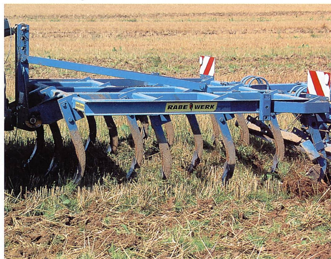
Abb. 4: Traditionelle Doppelherzschargrubber eignen sich hervorragend zum Einmischen von Stroh bei Arbeitstiefen von zirka 15 cm. Für flaches Arbeiten ist eine Umrüstung auf Gänsefusschare notwendig.
