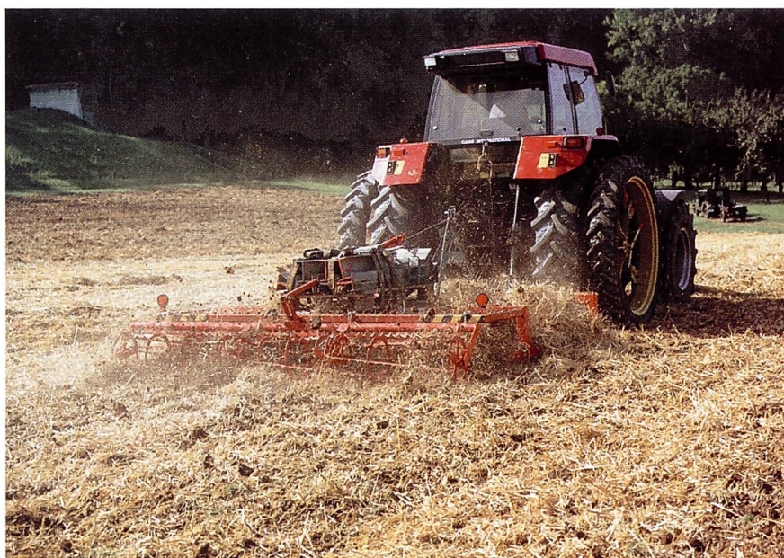
Abb. 5: Spatenrolleggen mischen Stroh oberflächlich ein, besitzen eine hohe Schlagkraft und einen kleinen Zugkraftbedarf. Da sie den Boden nicht ganzflächig bearbeiten, weisen sie bezüglich der Unkrautregulierung Schwächen auf.
