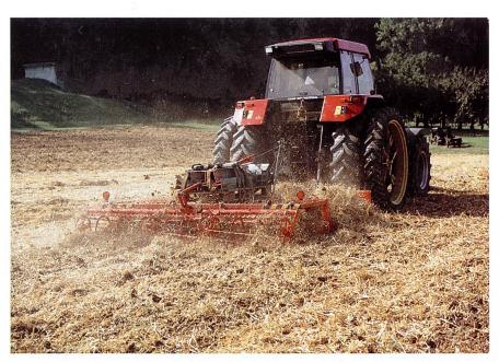
Abb. 5: Spatenrolleggen mischen Stroh oberflächlich ein, besitzen eine hohe Schlagkraft und einen kleinen Zugkraftbedarf. Da sie den Boden nicht ganzflächig bearbeiten, weisen sie bezüglich der Unkrautregulierung Schwächen auf.
