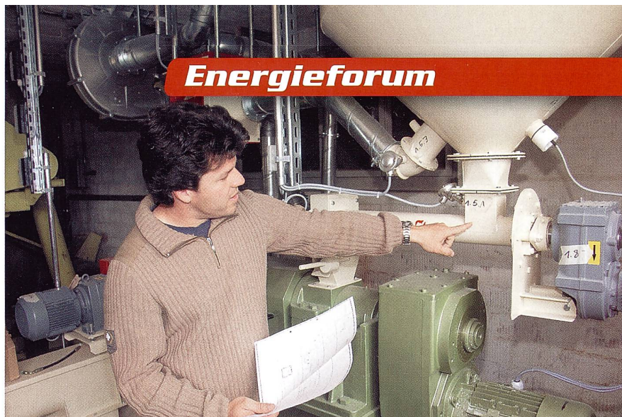
Für die Ölpresse in der Landi Suberg können zum Teil die bestehenden Anlagen neu genutzt werden. Matthias Stettler erklärt die Funktionen der einzelnen Bauteile der neu installierten Seiherschnellenpresse.
