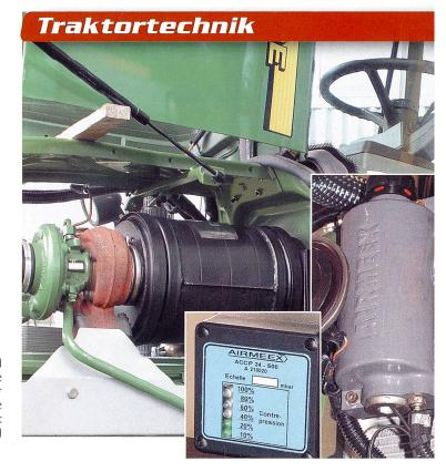
Filter, Additivtank und elektronische Steuerung sorgen für fast partikelfreie Traktorabgase. (Fotos: Edith Moos-Nüssli)
