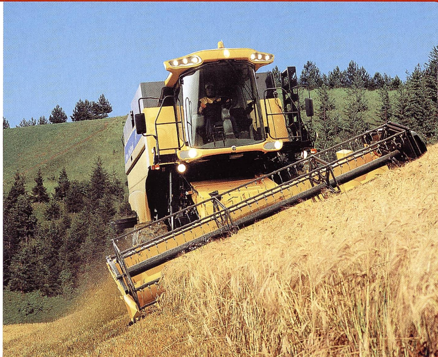
New Holland CL 560: Hangmähdrescher mit hydraulischem Fahrwerksausgleich längs und seitlich.
