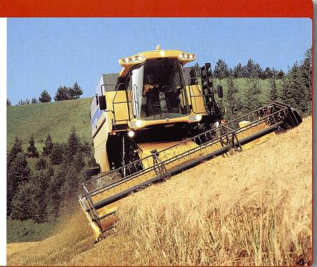
New Holland CL 560: Hangmähdrescher mit hydraulischem Fahrwerkausgleich längs und seitlich.
