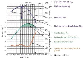
Abb. 5: Im Leistungsdiagramm sind die Leistung, das Drehmoment und der spezifische Verbrauch in Abhängigkeit der Motorendrehzahl angegeben.
