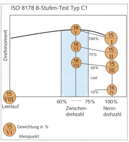
Abb. 6: Mit diesem Messzyklus wird das Abgas gemessen.
