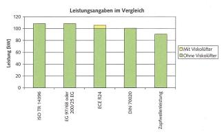
Abb. 2: Vergleich der Leistungen, bei unterschiedlichen Messnormen, eines Fahrzeugs, dessen Motor 100 DIN-kW leistet. Die Werte sind nur als ungefähre Werte zu verstehen und können je nach Motortyp und Fahrzeug leicht abweichen.
