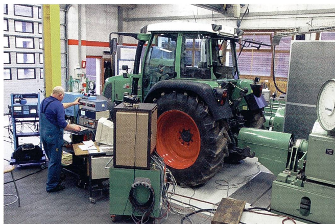
Abb. 1: Agroscope FAT Tänikon misst die Leistung an der Zapfwelle. Diese Leistung steht auch wirklich für zapfwellenbetriebene Geräte zur Verfügung.
