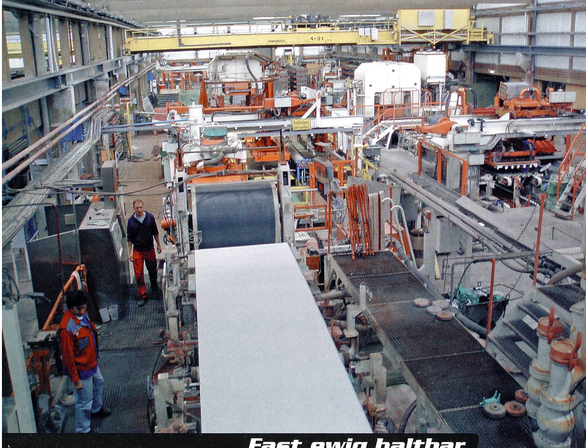
Walzen bauen die Eternitplatten Schicht um Schicht auf.
