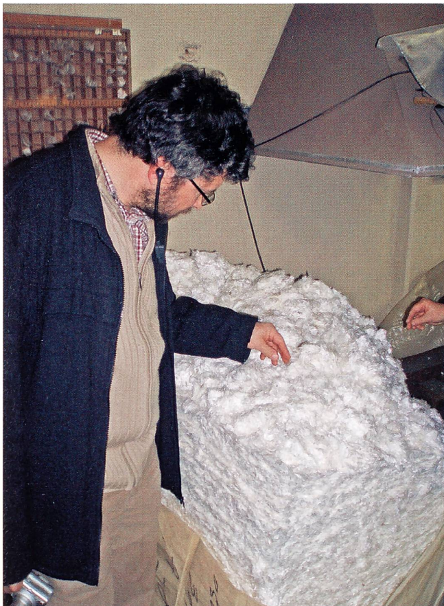
Textilfasern haben die Asbestfaser als «Armierungsmaterial» abgelöst.
