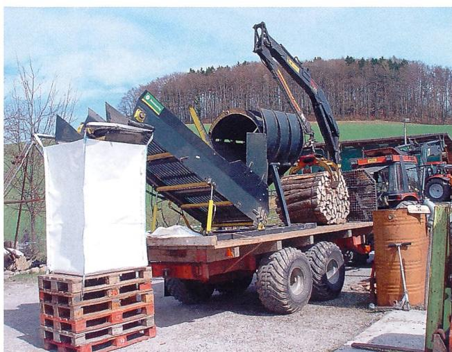
Mit dem aufgebauten Bündelprozessor lassen sich Sterbündel direkt auf 25 bis 50 cm zersägen.
