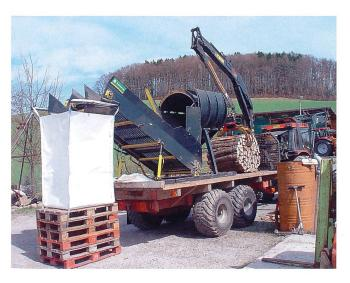
Mit dem aufgebauten Bündelprozessor lassen sich Sterbündel direkt auf 25 bis 50 cm zersägen.
