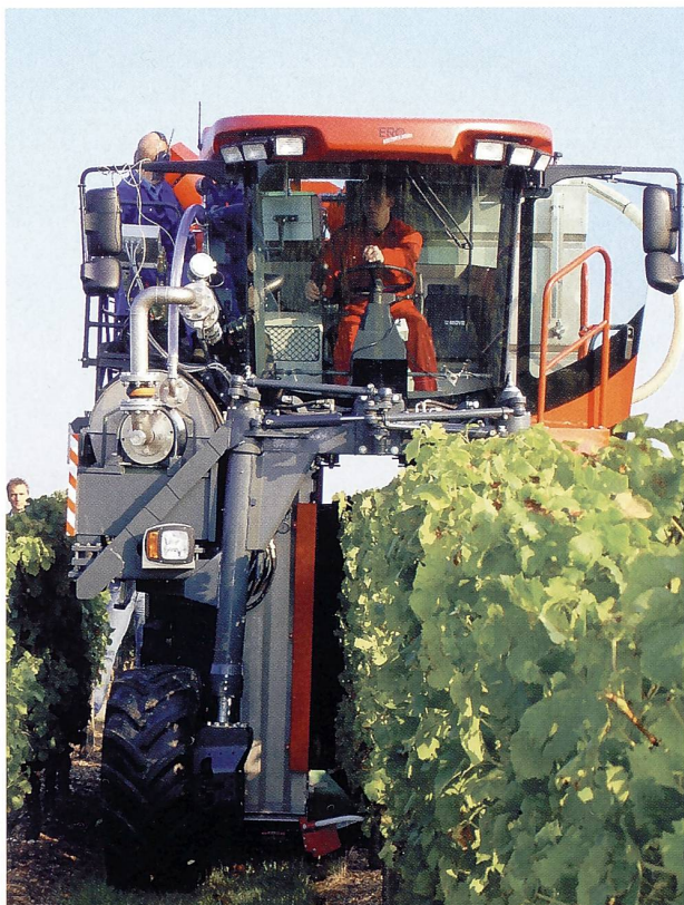
Die Kombination von Ernte und Entsaften in einer Maschine funktioniert. Foto: Hochschule Wädenswil
