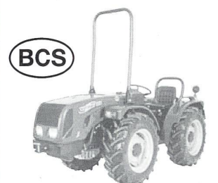
BCS Valiant AR - Knicklenker Wendetraktor für Wein-, Obst-, Gemüse- und Beerenbau. 46 PS, schmalste Spur Aussen/Aussen 1058mm, kleinster Wenderadius 2800mm, Gewicht 1155 kg
