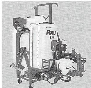
Viele weitere Vorteile – von einem grossen Klarwasserbehälter (120 l) über ein übersichtliches und gut zugängliches Bedienungszentrum bis hin zu Gleichdruckarmaturen – vereinfachen dem Anwender die Bedienung und erhöhen die Leistungsfähigkeit.
