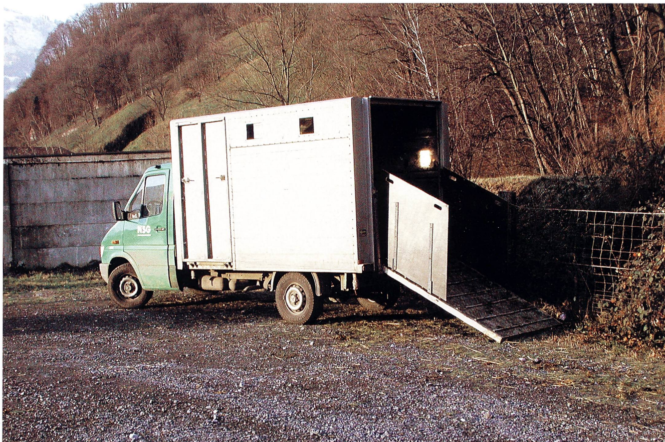
Gleitsichere Rampen und Seitenschutz sollen verhindern, dass sich Tiere beim Verlad verletzen. Quelle: Veterinäramt St. Gallen
