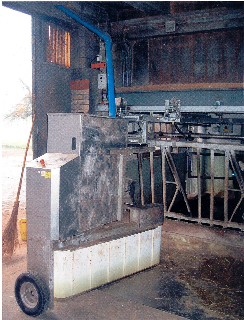
Abb. 2: Die Befüllung des Butler-Plus erfolgt vorteilhafterweise vollautomatisch über ein Förderaggregat (blaues Rohr). In der Parkposition lädt das Ladegerät die Akkus auf.
