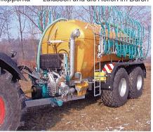
messer immer grösser werden, war eine Verbesserung der Lenkgeometrie längst überfällig. Die Achse ist zusätzlich mit einem mechanischen Lenkstabilisator ausgerüstet, der die Verkehrssicherheit erhöht.
