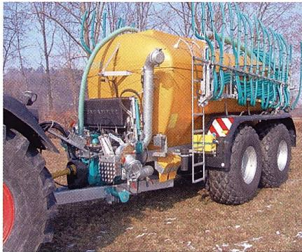
messer immer grösser werden, war eine Verbesserung der Lenkgeometrie längst überfällig. Die Achse ist zusätzlich mit einem mechanischen Lenkstabilisator ausgerüstet, der die Verkehrssicherheit erhöht.
