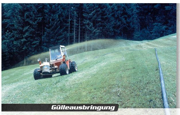
Bezüglich Ausbringleistung, Hangtauglichkeit und Bodenschonung ist die Gülleverschlauchung unschlagbar!
