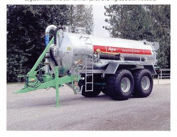
Pendelverteiler am Fass sind eine interessante Alternative zum Prallteller: grobtropfige, exakte Verteilung auf grosser Arbeitsbreite.
