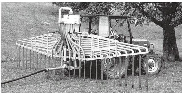
**Gülleausbringung mit geringstem Stickstoffverlust und minimalen Geruchsemissionen**
