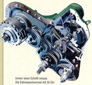
Die Vielmessertrommel mit 56 Einzelmessern gestattet jetzt – zusammen mit dem stufenlosen Schnittlängengetriebe – die stufenlose Wahl der Schnittlänge zwischen 4 und 19 mm. Die neue, maximal mögliche Schnittlänge sorgt für eine höhere Leistung bei geringerem Kraftstoffverbrauch und bietet immer die optimale Häckselqualität und Struktur für Ihre Kunden. Gleichzeitig sind Sie in der Lage, exakt gleichmäßig kurz zu häckseln, perfekt für Biogasanlagen.
