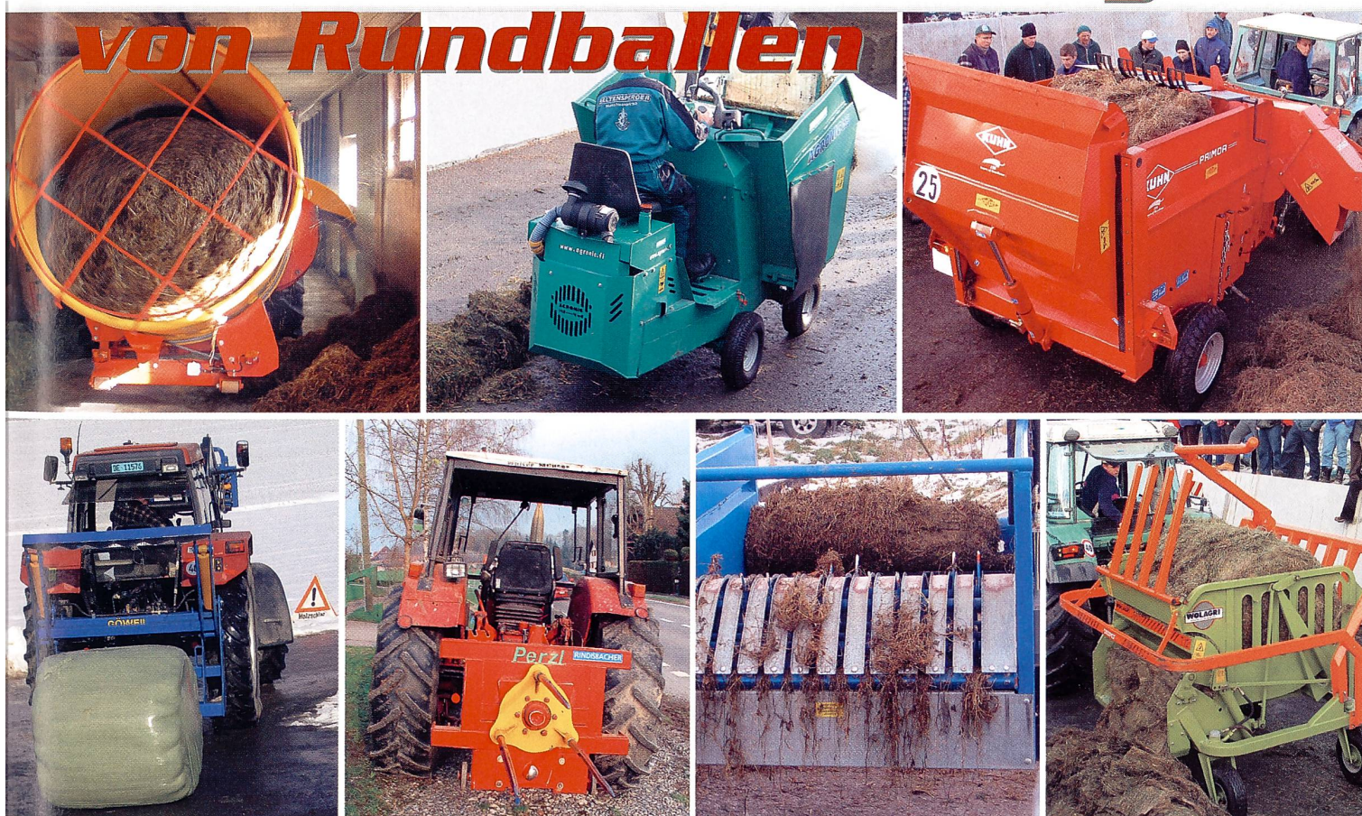
Abb. 1: Unterschiedliche Geräte erleichtern das Auflösen und die Vorlage von Rundballen. Bei der Wahl des passenden Geräts spielen Bestandesgrösse, Einsatzmöglichkeiten, Auslastung, Futterration, Futterlager, vorhandene Fütterungstechnik, Zugmaschine und räumliche Gegebenheiten eine grosse Rolle.
