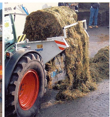
Abb. 2: Drei verschiedene Typen von Rundballenschneidern: Rundballenzerteiler mit schwertartigem Messer (Bild links); Silageschneidezangen mit entsprechend grossem Öffnungswinkel können auch Rundballen schneiden (Bild rechts)
