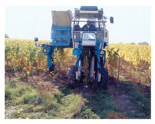
zialtraktoren mit Allrad oder hydrostatischem Antrieb bevorzugt wird. Für die Mechanisierung von Bodenbearbeitung, Begrünungspflege, Düngung, Pflanzenschutz und Laubschnitt steht eine Vielzahl von Anbaugeräten zur Verfügung. Diese können im Front-, Zwischenachs- oder Heckbereich angebaut werden. Mittels Traubenerntemaschinen ist heute auch die Weinlese voll mechanisierbar.
