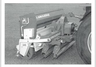
Die Rüttelegge, ausgestattet mit Vertikutierzinkenbalken, wird zusammen mit der Grassämaschine zu einer idealen Nachsaat-Kombination. Sie erledigt zuverlässig die Regeneration von beschädigten Grasnarben. Die Grassamen werden beim Vertikutiervorgang mit loser Erde vermischt und mit der nachlaufenden Gitter- oder Glattwalze angedrückt.
