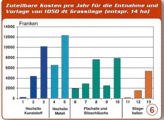
mit dem Mischwagen vorgelegt wird (*Gra-fik 4*). Beim hier zu Grunde gelegten Silagevolumen bewirkt der Metallsilo verhältnismässig hohe Investitionen pro Kubikmeter. Bei grösserem Stapelvolumen können Metallsilos mit Kunststoffsilos finanziell eher konkurrieren: Ab zirka 350 m³ Lagervolumen entsteht Kostengleichheit.
