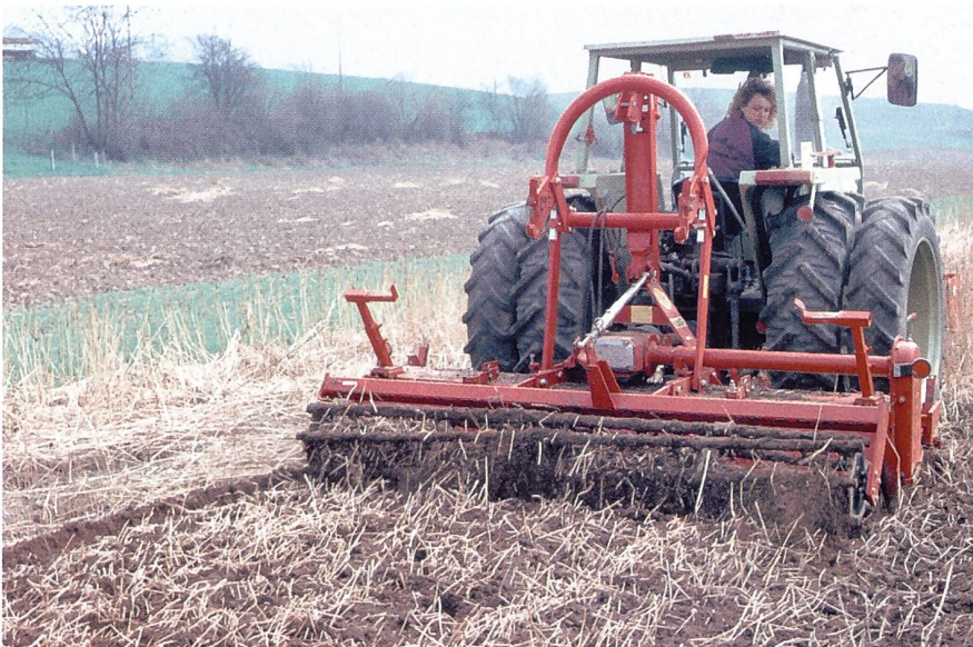
Flaches Einarbeiten der Pflanzenrückstände beispielsweise mit Flachgrubber oder Zinkenrotor (Bild: SFZ)
