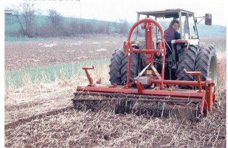
Schwere Mulchsämaschine mit aufgebautem Düngerstreuer (Bild: Stefan Wyss)
