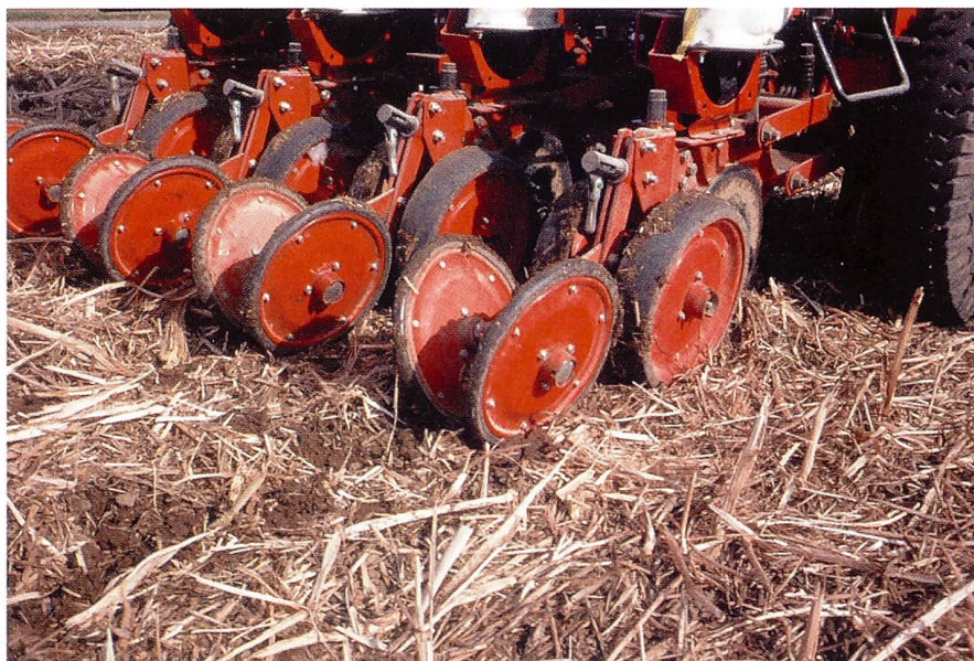
«Multifunktions»-Direktsaatmaschine Semeato bei der Rübensaat in einen abgefahrenen Ölrettichbestand. (Bild: Stefan Wyss)
