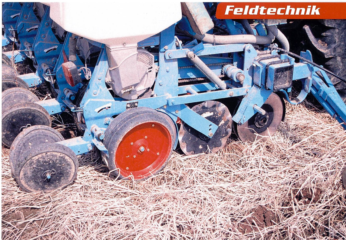
Direktsaat in einen abgefrorenen Senfbestand. Für die Direktsaaten eignen sich nur schwere Spezialgeräte, wobei auf einen ausreichend abgetrockneten Boden zu achten ist. (Bild: SFZ)
