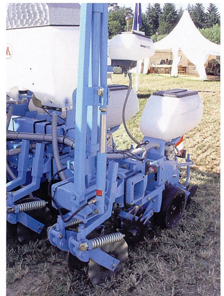
Schwere Mulchsämaschine mit aufgebautem Düngerstreuer (Bild: Stefan Wyss)
