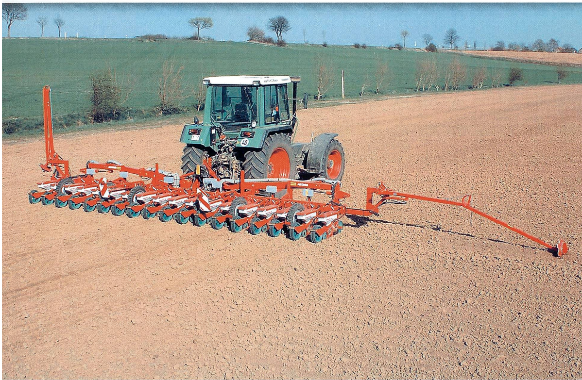
Grosse Arbeitsbreite mit mechanischer Einzelkornsämaschine dank geringem Gewicht (Bild: zvg)
