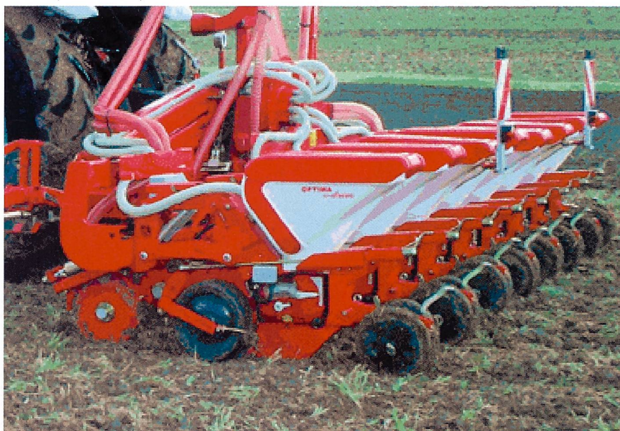
Einzelkornsätechnik für Mais, Rüben, Bohnen, Sonnenblumen und mehr mit Arbeitsbreiten von 3 bis 9 m, für Normal-, Mulch- und Direktsaat. Die Reihenweiten sind stufenlos verstellbar. (Bild: Werkbild)
