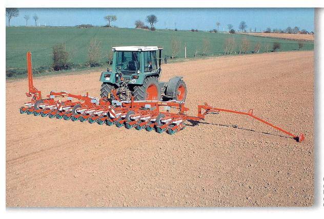
Grosse Arbeitsbreite mit mechanischer Einzelkornsämaschine dank geringem Gewicht (Bild: zvg)
