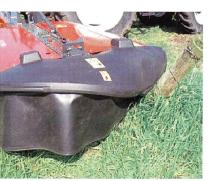
erleichtert den Zugang zu den Mähtrommeln für den Klingenwechsel und die Wartung.
