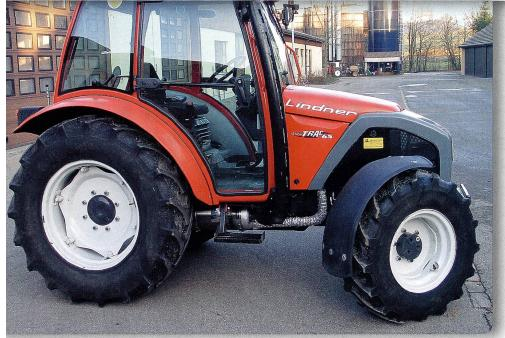
Der Einbau des Filters stellt ein besonderes Problem dar. Die Filter sind grösser als die originalen, zu ersetzenden Schalldämpfer. Die Partikelfilter können deshalb nur selten unter der Motorhaube eingebaut werden. Bewährt hat sich der Einbau des Filters entlang der Kabine.
