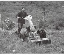
Schnitthöhe kann bequem über eine Laufrolle eingestellt werden. Das Grüngut wird ebenfalls nach hinten abgelegt. Arbeitsbreiten sind von 70 bis 128 cm wählbar.
